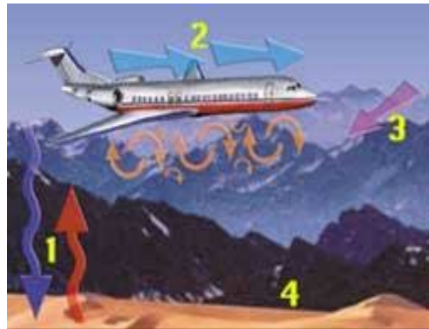
Abbildung 2.2: Illustration der Bereiche mit Turbulenz: (1) konvektiv, in Bodennähe, (2) CAT en-route , (3) über Bergen, (4) dynamisch verursacht in Bodennähe.
