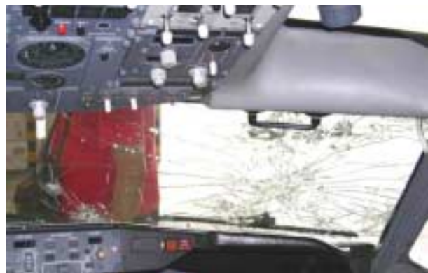
Abbildung 2.13: Hagelschäden an einer B737 bei Genf am 15. August 2003.
