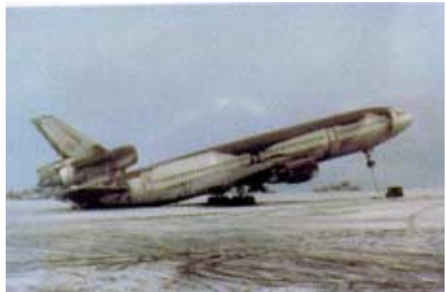
Abbildung 2.15: Durch Vulkanasche beschädigtes Flugzeug.
