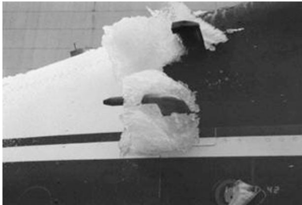
Abbildung 2.12: Eisansatz an einer DO-28 der DLR nach Vereisungsmeßflug; Aufnahme am Boden nach der Landung.
