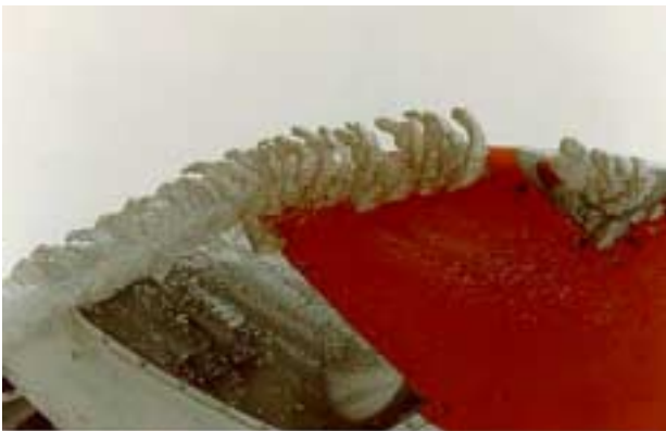
Abbildung 2.3: Fingerförmiger Eisansatz am Flügelende einer DO-28 des DLR.
