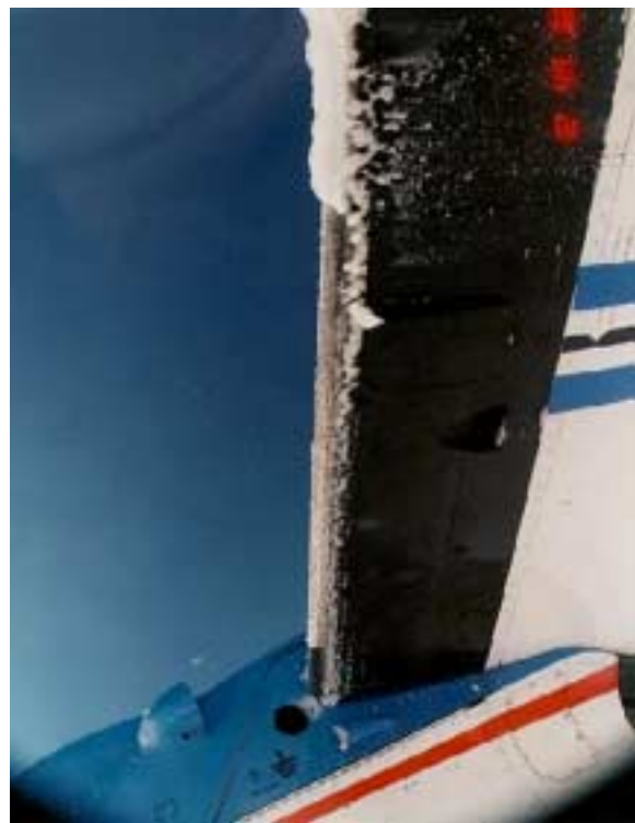
Abbildung 2.4: Eisansatz an der Flügelvor-derkante einer DO-128 des DLR während ei-nes Meßfluges zur Untersuchung der Flug-zeugvereisung während der EURICE-Meßkampagne, nach erstmaliger Aktivierung der boots , Aufnahme von unten; im Bild unten die Triebwerksgondel. Foto: T. Hauf.
