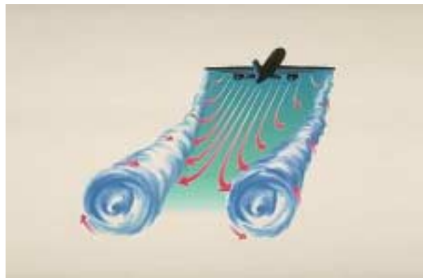
Abbildung 3.1: Illustration der gegensinnig rotierenden Wirbel.
