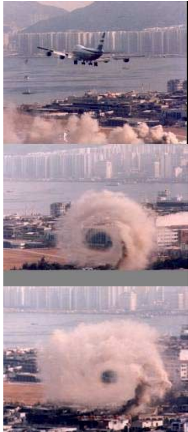
Abbildung 3.2: Sequenz mit Wirbelschleppen beim Anflug auf den alten Flughafen von Hongkong.
