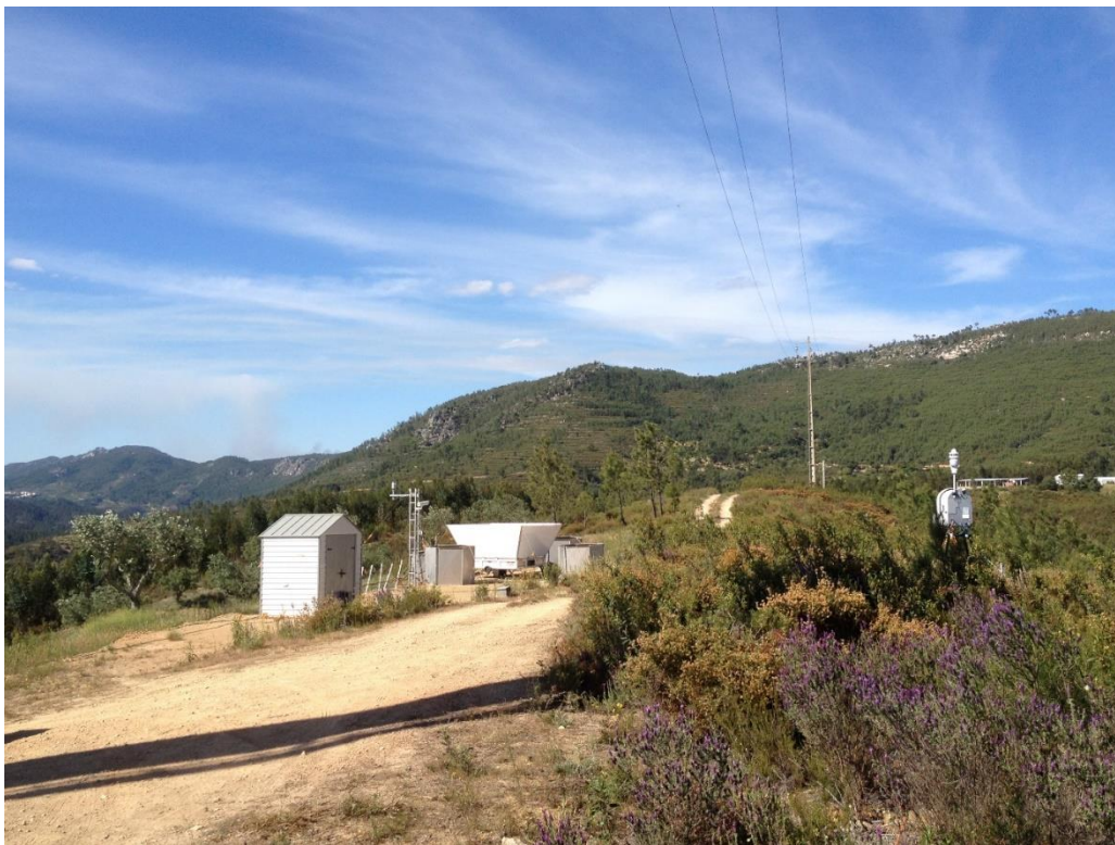
Abbildung 5: Windprofiler mit RASS (links) und Radiometer (rechts) auf einem Geländerrücken nahe Perdigão (© Martin Hagen)
